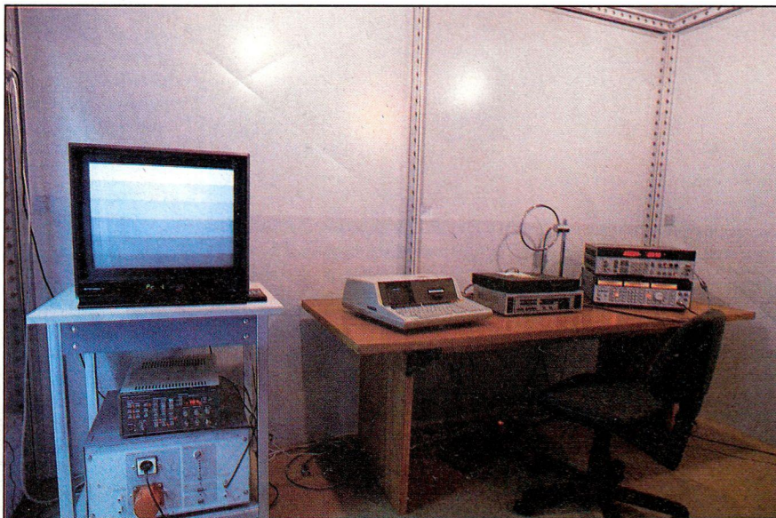
Il set di misura per la rilevazione dei disturbi indotti via rete: in basso a sinistra la Rete Artificiale Rohde & Schwarz ESH-2-Z5.
